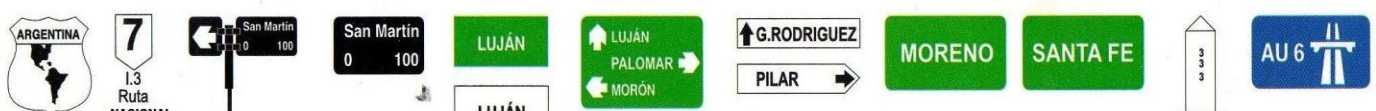
I.1 Ruta panamericana I.2 Ruta PROVINCIAL I.3 Ruta NACIONAL I.4 (a) Nomenclatura urbana I.4 (b) Nomenclatura urbana I.5 Identificación de región o localidad I.6 Orientación (en caminos primarios y secundarios) I.7 Orientación (en caminos secundarios) I.8 Comienzo o fin de zona urbana I.9 Identificación jurisd. o acc. geog. I.11 Nomenclatura de autopista.
